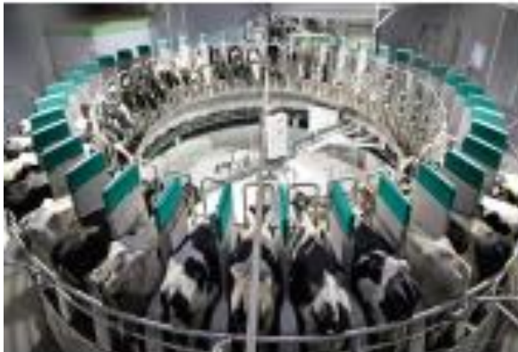
Hệ thống vắt sữa xoay vòng
